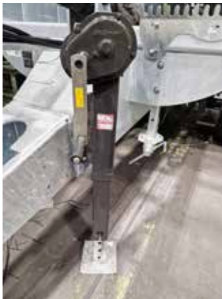
Stützfuß mit 2-Geschwindigkeiten
