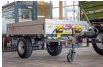
Superleicht: Der EDK 25 mit ALU-Bordwänden und Laubaufsatz
