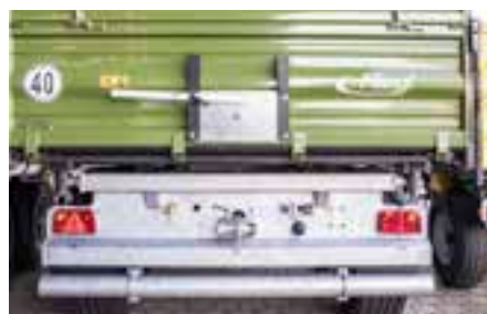
40 km/h Ausführung mit Unterfahrschutz und Kotflügel
