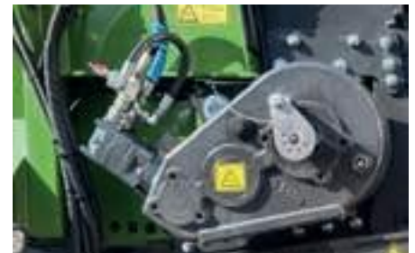
Kratzbodenantrieb Stirnradgetriebe und Hydraulikmotor in Fahrtrichtung links
