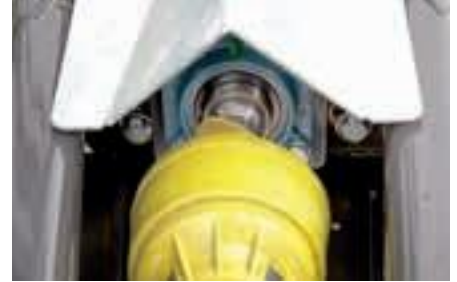
Bordhydraulik 60 Liter (optional 90 L) angetrieben durch Zapfwellenantrieb mit Hydraulikpumpe und Ölbehälter
