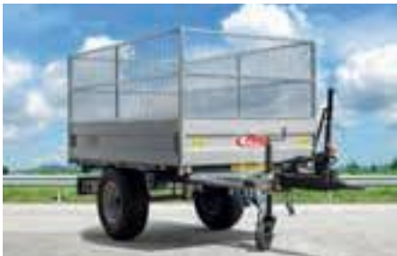
Superleicht: Der EDK 25 mit ALU-Bordwänden und Laubaufsatz
