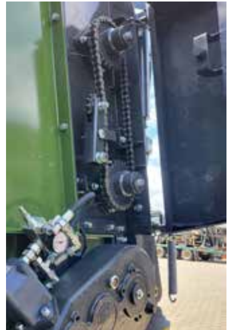
Fräswalzenverbindung über Kette (KDS 255)
