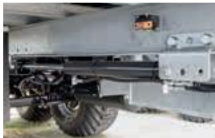
Achsverschiebung mechanisch..... oder hydraulisch (ab ASW 271)
