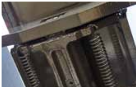
Automatische Hakenverriegelung beim Kippvorgang
