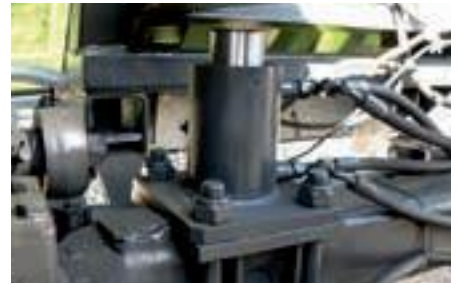
Optional: Hydraulische Abstützung auf die Achse
