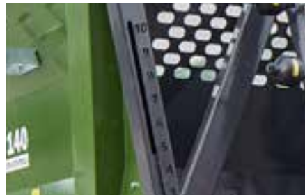
Die Stauschieberöffnungsskala an der Stirnseite zeigt die Öffnungsposition des Stauschiebers an.
