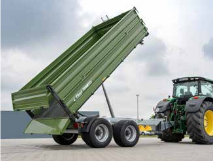
Schotterklappenausführung mit hydraulischer Heckklappe 500 mm.
