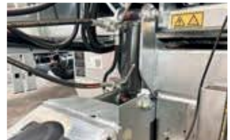
Zugholm hydraulisch gefedert, drehbar für Oben- und Untenanhängung
