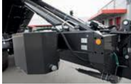
Bordhydraulik 60 Liter (optional 90 L) angetrieben durch Zapfwellenantrieb mit Hydraulikpumpe und Ölbehälter
