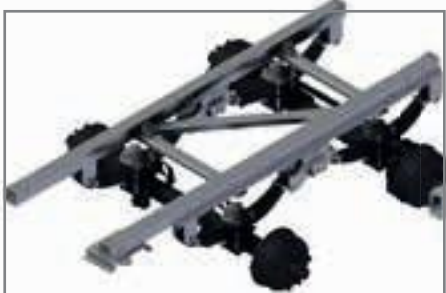
Gigant-Tandemaggregat (TMK 200 ab 5,65 m Muldenlänge)
