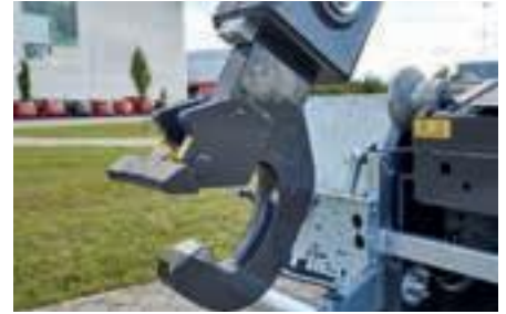
Geschmiedeter, einfach auswechselbarer Aufnahmehaken
