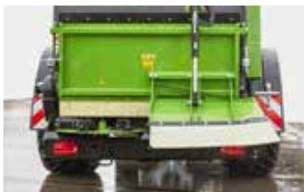
Randstreueinrichtung Als Einzelbau links oder rechts bzw. auch beidseitig erhältlich.
