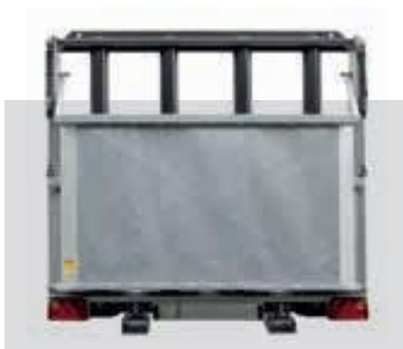
Streuwalzenschutz und Stauschieber (optional) beim ADS 60
