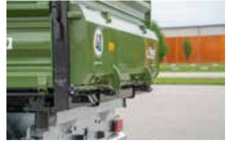
robuste klappe mit 2-Zylinder Ausführung
