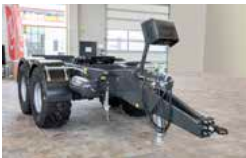
Tandem-Dolly mit 17 t Aufsattellast und 20 t Gesamtgewicht
