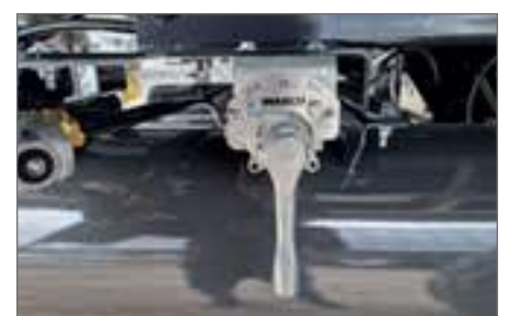
Heben- und Senkenventil bei Luftfederung
