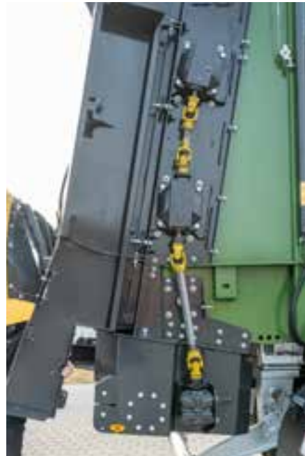
Fräswalzantrieb über Gelenkwelle
