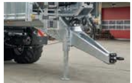
Zugholm ungefedert, drehbar für Oben- und Untenanhängung
