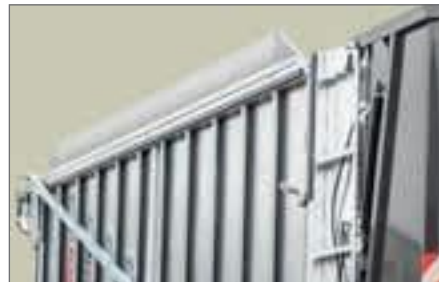
Aluminiumaufbau 300 mm seitlich
