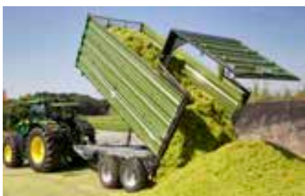
Silierkipper mit hydraulischer Rückwand
