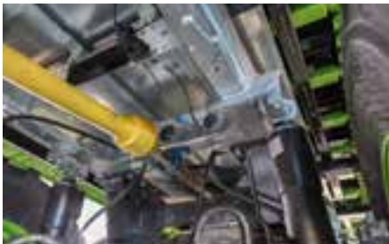
Bei KDS Tandem und Tridem: Fahrwerksabdeckung (gegen Mist)
