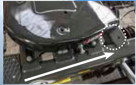
Mechanische Sattelplattenverstellung für Einachs- und Tandem-Dolly
