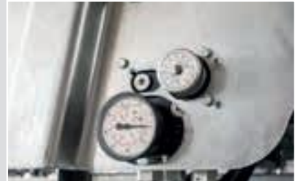
Mechanisches Potentiometer mit einstellbarer Vorschubgeschwindigkeit am Streuwerk
