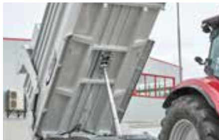
Schwerer Brückenrahmen für extreme Verwindungssteifheit
