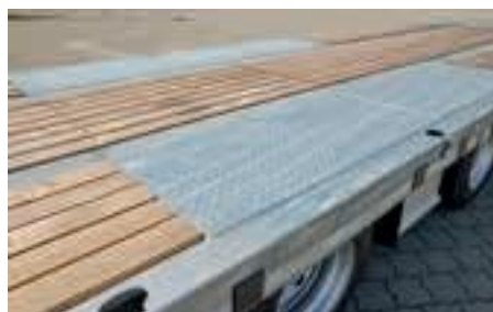
Auffahrampen und Brückenboden aus Weichholz
