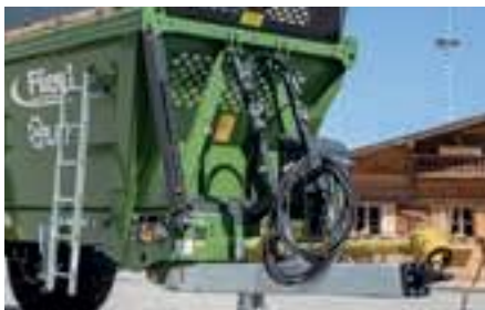
Hydraulisch gefederte Zugdeichsel. Die Anhängöhe kann bequem eingestellt werden.
