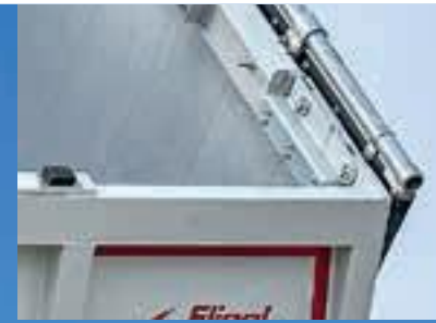
Doppelgelenkscharnier und 2-fache Hakenverriegelung
