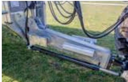
Optional: Hydraulische Zwangslenkung
