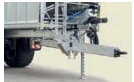
Durchgehend hydr. gefederte Zugeinrichtung für Untenanhängung
