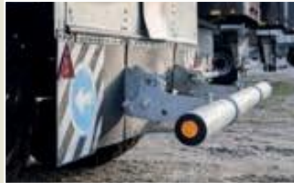
Unterfahrerschutz mechanisch klappbar
