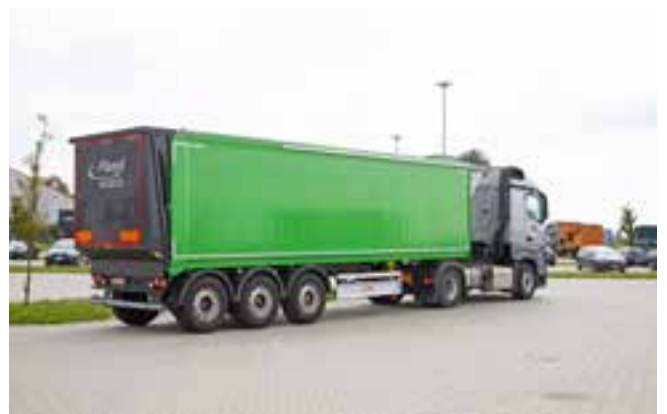
ASS 398 GREEN-TEC mit Seitenwände aus Aluminium
