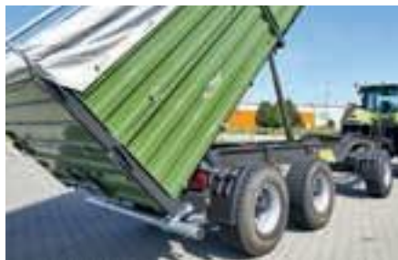
Zentralverriegelung in SERIE: links, rechts und hinten
