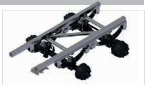
Tandemaggregat Gigant – Parabelfederung
