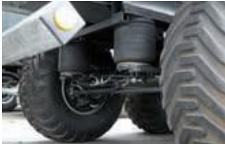
Optional: Luftfederung mit automatischer Kippabsenkung
