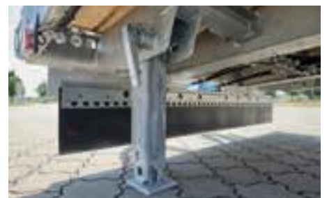
Heckabstützung mit 2 Fallstützen
