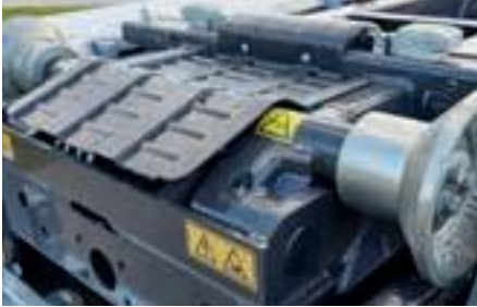
Große Stahlguss-Ablaufrollen (ø 310mm) mit großer Zentrierschräge erleichtern das Aufziehen des Containers.
