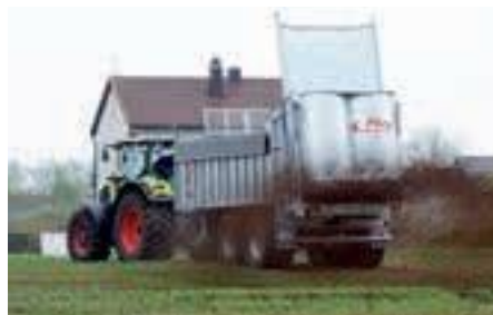
Streuwerk »Profi V2« mit geschlossener Breitstreuerrückwand für trockene Streugüter
