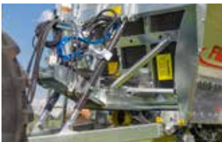
Hydraulische Deichselfederung, bester Fahrkomfort
