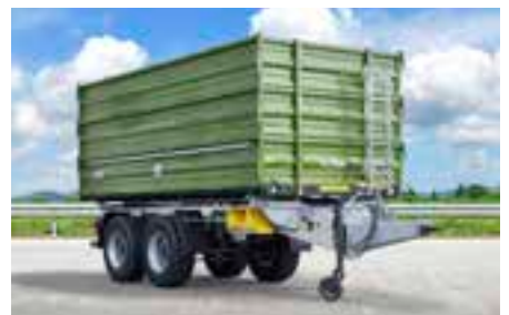
TDK 160 mit Aufbau 1800 mm (3 x 600 mm Bordwand)
