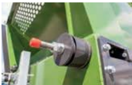
Kettenspanner Die ausreichende und gleichmäßige Spannung ist die Grundvoraussetzung für den zuverlässigen Materialtransport. Die Spannelemente befinden sich an der Muldenvorderseite.
