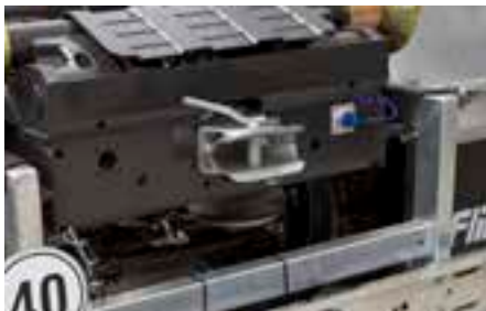
Optional: Bremsanschluß und Hydraulik für 2. Anhänger
