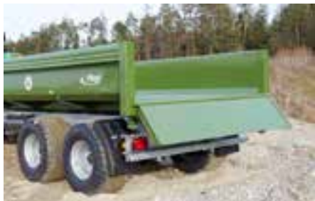
Schotterklappe bei TMK 130 S und TMK 200 S
